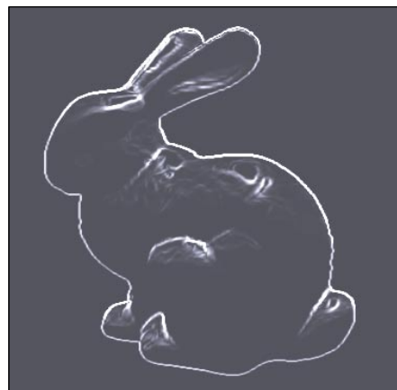
Der Sobel-Filter: Diese Technik bewältigt eine D3D9-Grafikkarte leicht.
